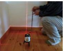
「床の傾きを計測する」調査機器
